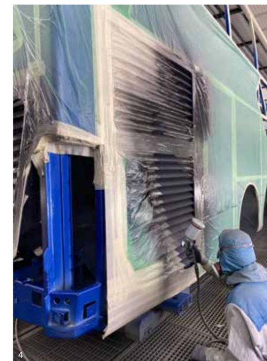
der sogenannten Decklackbeschichtung, versehen wird. Abschließend folgen die Innenraum- und Hohlraumbeschichtung sowie die Endmontage der verarbeiteten Karosserieteile.
